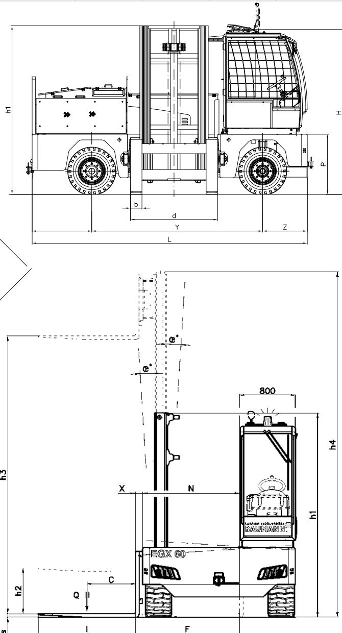
**Neuigkeiten?** Dieser Elektro-Seitenstapler mit 120V AC Technologie garantiert unglaubliche Effizienz, somit lange Einsatzzeiten, und dies trotz größerer Fahr und Arbeitsgeschwindigkeiten. Das Schnellwechselsystem der Batterie ermöglicht auch Einsätze im Mehrschichtbetrieb. Der VRS (variable reach System), das prämierte und patentierte Ausfahrwerk gewährt Präzision, Geschwindigkeit und reduzierte Wartung.
