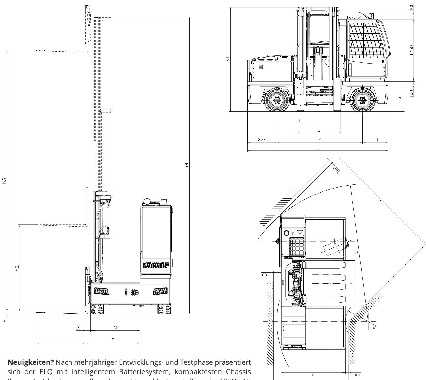
**Neuigkeiten?** Nach mehrjähriger Entwicklungs- und Testphase präsentiert sich der ELQ mit intelligentem Batteriesystem, kompaktesten Chassis (kürzer 4m), load sensing flow-sharing Steuerblock und effizienter 120V - AC Technologie sowie niedrigem Schwerpunkt. Komfort, Manövriertfähigkeit, Effizienz und Power machen den ELQ zum Profi der Kleinmaschinen für den innen- und außen-Einsatz! Eine Plattformhöhe von 750mm auch für den ELQ 50 garantiert bestmögliche Lagereffizienz.
